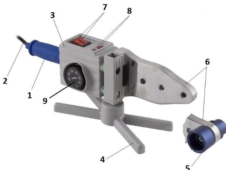
Сварочный аппарат состоит из алюминиевого корпуса (3), нагревательной панели (6), обрезининовой ручки (1) сетевого кабеля (2) с вилкой и подставки (4). Нагревательная панель изготовлена из алюминиевого сплава, внутри которой встроено два независимых нагревательных элемента (ТЭНа) мощностью по 750 Вт каждый. Любой из элементов может быть включён или выключен независимо отдельным выключателем (7) на панели управления аппарата.
